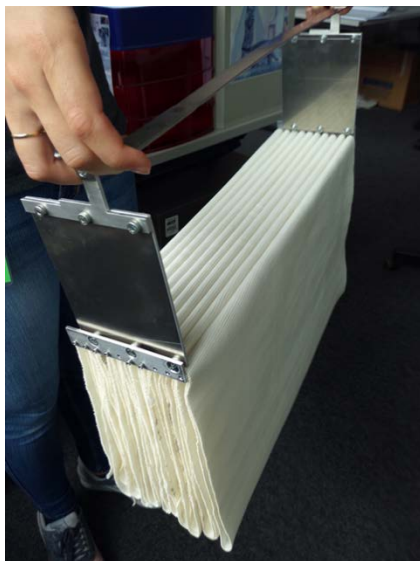
Abb. 2: PCM Speicher- Gestrick-Struktur und PCM Speicher- Noppen-Struktur
