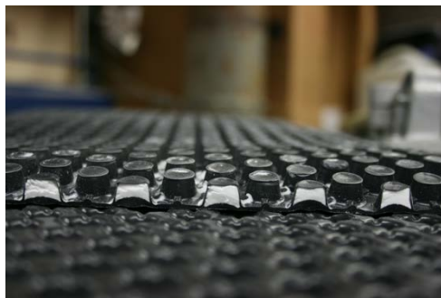
Abb. 2: PCM Speicher- Gestrick-Struktur und PCM Speicher- Noppen-Struktur
